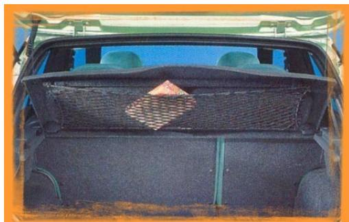
**Standard:** si fissa direttamente alla cappelliera. E' importante che nella cappelliera siano presenti due nervature trasversali (di solito tubolari quadri in lamierino) a cui fissare le viti senza che sporgano al di sopra della cappelliera.
